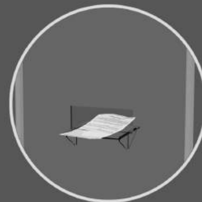
FESSURA CENTRALE CREATA PER IL PASSAGGIO DI DOCUMENTI
