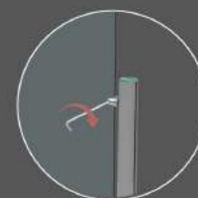
SISTEMA DI FISSAGGIO PANNELLO
